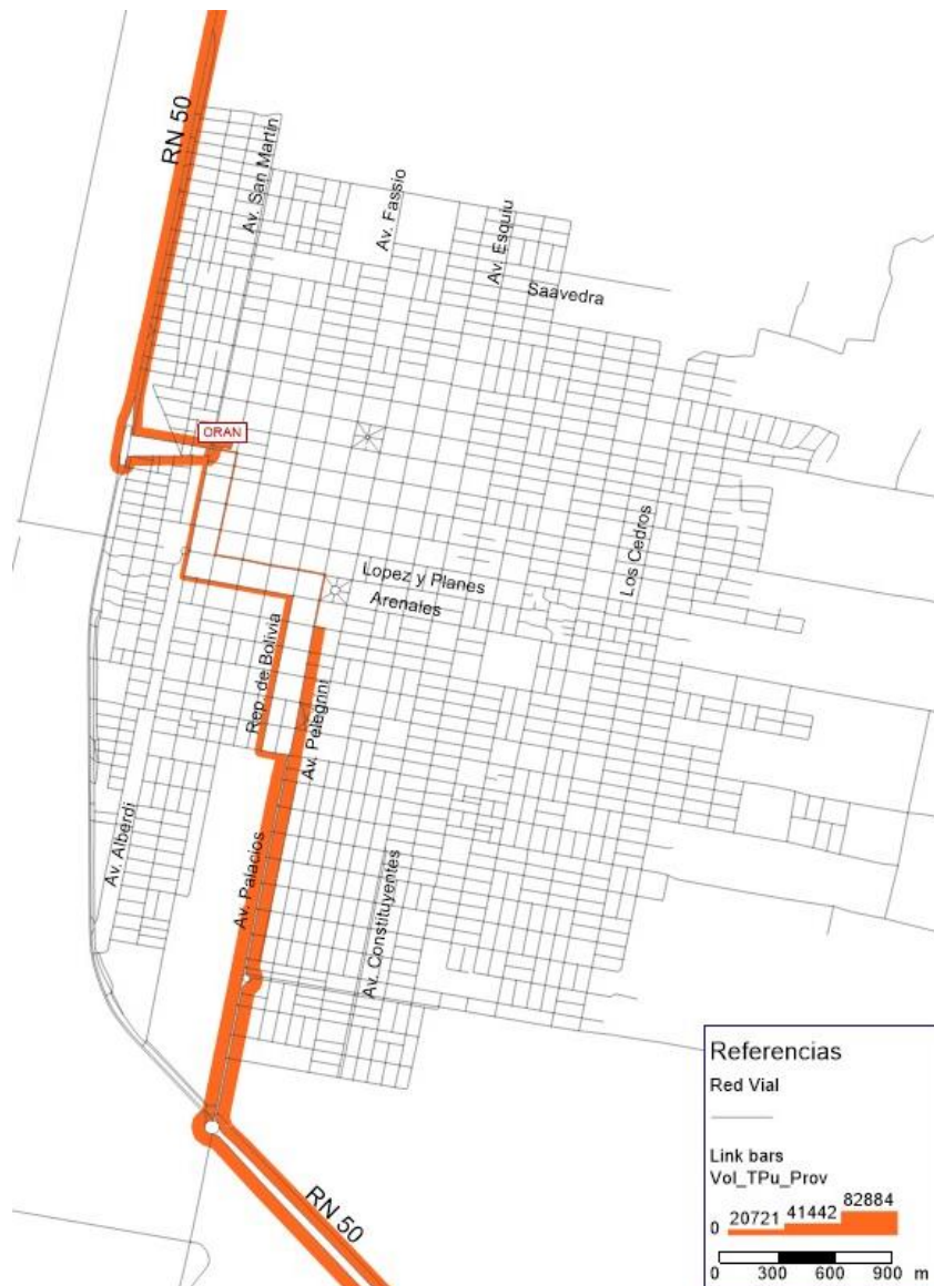
Imagen 73. Gráfico de asignación de pasajeros de transporte público en líneas interurbanas por mes en el AMO.
